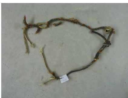
Notare la tipologia di rottura multipla
