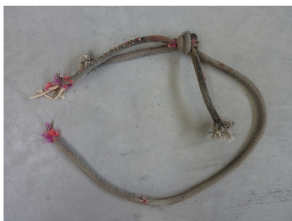
Punto di rottura esterno al nodo
